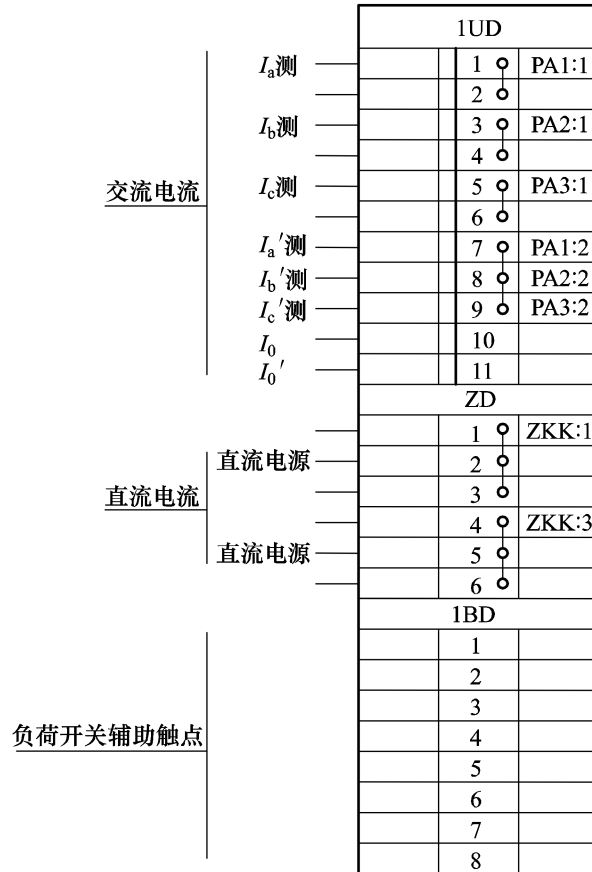
图 1 进、出线柜端子排图
